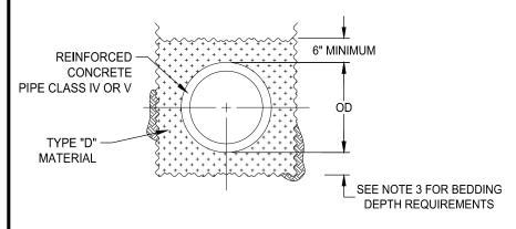
INITIAL BACKFILL REQUIREMENTS FOR SHALLOW PIPE - OPTION 2
